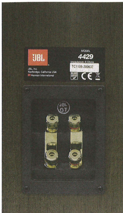
Quattro i morsetti a disposizione per doppia amplificazione e doppio cablaggio.
