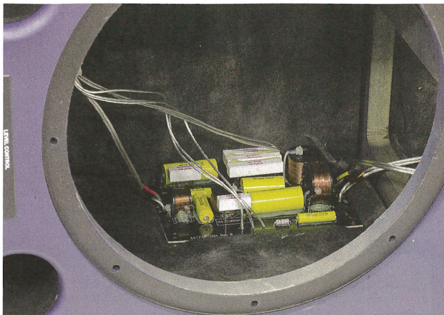
Il supporto del filtro crossover della sezione medio-alti. Sulla destra vediamo anche parte del rinforzo anulare del mobile.
